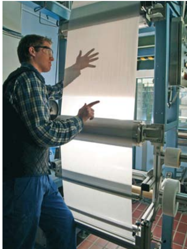
Mit nanoskaligen Sinterhilfsmitteln versehen, kann die Folie bei vergleichsweise niedriger Temperatur gebrannt (gesintert) und so kostengünstig „roll to roll“ produziert werden.
