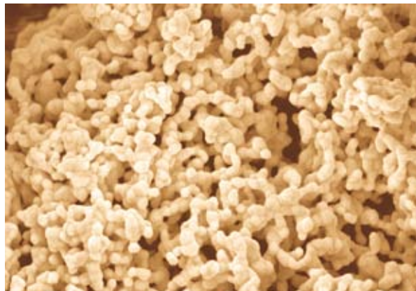
Rasterelektronenmikroskopische Aufnahme von Silber-Nanopartikeln, mittlere Primärpartikelgröße 50-200 nm
