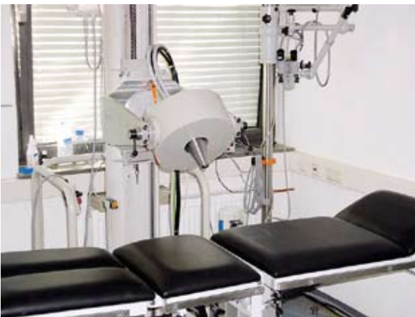
Hochgradientenmagnet zur Steuerung von Magnetpartikeln im Körper. Der im Rahmen des Projektes „Nanomagnetomedizin“ des BMBF entwickelte Magnet ist mit 47 kg leicht genug, um am Bett des Patienten geschwenkt werden zu können. Der Vorgängermagnet wog 1,5 Tonnen.
