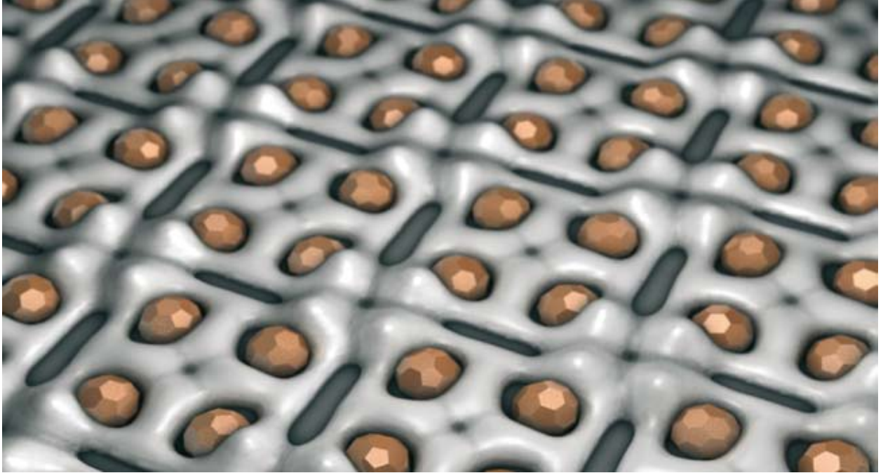
Perfekte Palladium-Nanokristalle wachsen in den Poren einer Bakterienhaut.
