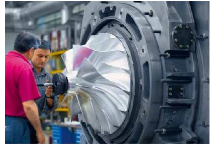
ABB-Turbolader für Schiffsdieselmotoren von 5-25 MW [2]
